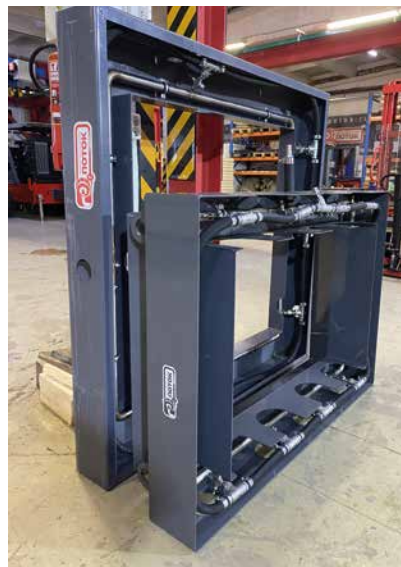
Станция обеспыливающего смачивания
