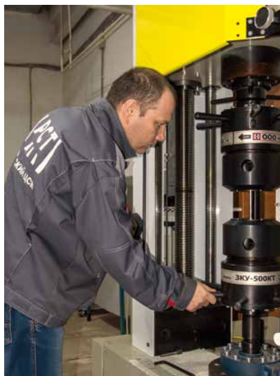
Ведущий инженер опорной лаборатории Евгений Бакулин закрепляет образец в разрывной машине
